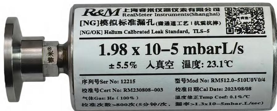
圆柱体电池NG标准漏孔， $\phi$  38mm x95mm
