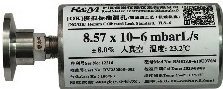
圆柱体电池OK标准漏孔， $\phi$  38mm x95mm
